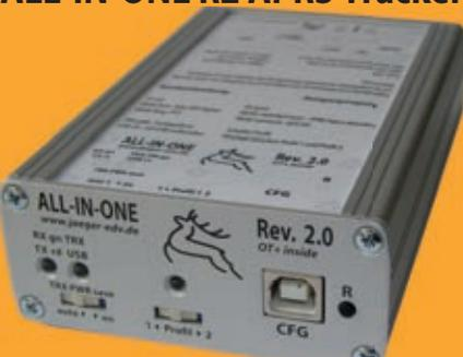
**Mobil Tracker** 124/82/35 mm (L/B/H) zum Übermitteln des Standorts in das APRS Netz. Integrierter 2m / 70cm TRX mit SW und GPS Empfänger SIRF starIV. Konfiguration über USB Port. Der ALL-IN-ONE R2 Tracker wird durch einen Opentracker+ mit 2 Profilen und weiteren Features gesteuert. Profilwechsel durch Schalter. Trigger gesteuerte Aktivierung und zeitgesteuerter Nachlauf von 45 Min. mit anschließender kompletter Abschaltung des Trackers bis zum nächsten Trigger Impuls.
