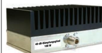
Bausatz für einen bis 150 MHz nutzbaren 50-Ω-Abschlusswiderstand, der für Messzwecke über einen -40 dB-Ausgang (BNC) verfügt. Eingangsseitig hat der Dummyload eine N-Buchse. Komplettbausatz mit bearbeitetem Gehäuse und großem Kühlkörper.
