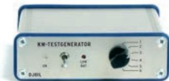
Komplettbausatz nach DJ8IL für einen abgleichfreien HF-Generator für 6 Pegel zwischen 50 mV (S9+60) und 0,4  $\mu$ V (S2); ausführliche Beschreibung im FA 2/2012. Es werden 5 Quarze für Frequenzen innerhalb der Amateurbänder mitgeliefert.
