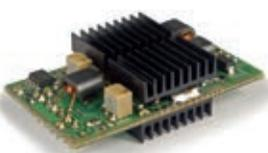
Bausatz nach H. Arnold, DL2EWN, (FA 2/2016) für einen besonders intermodulationsarmen 5-W-Linearverstärker ( $G_p=23$  dB) bestehend aus einer SMD-vorbastückten Platine sowie allen erforderlichen aktiven und passiven Bauelementen sowie 4 Kühlkörpern.
